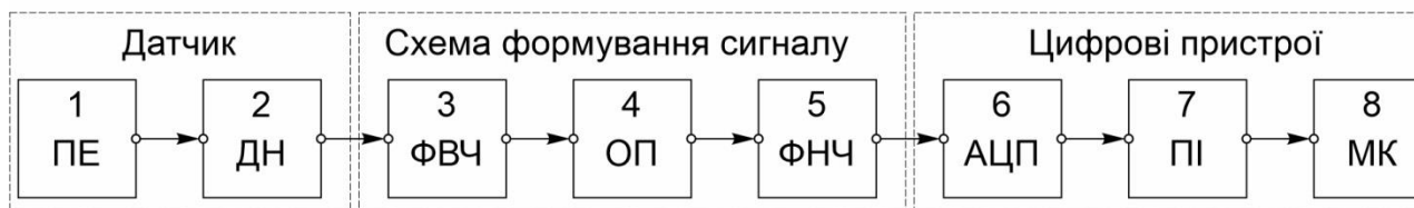
Рисунок 2. Загальна функціональна схема лабораторного пристрою, де 1 – п'єзоелектричний елемент (ПЕ), 2 – атенюатор або дільник напруги (ДН), 3 – фільтр високих частот (ФВЧ), 4 – операційний підсилювач (ОП), 5 – фільтр низьких частот (ФНЧ), 6 – аналого-цифровий перетворювач (АЦП), 7 – послідовний інтерфейс (ПІ), 8 – мікроконтролер (МК)
