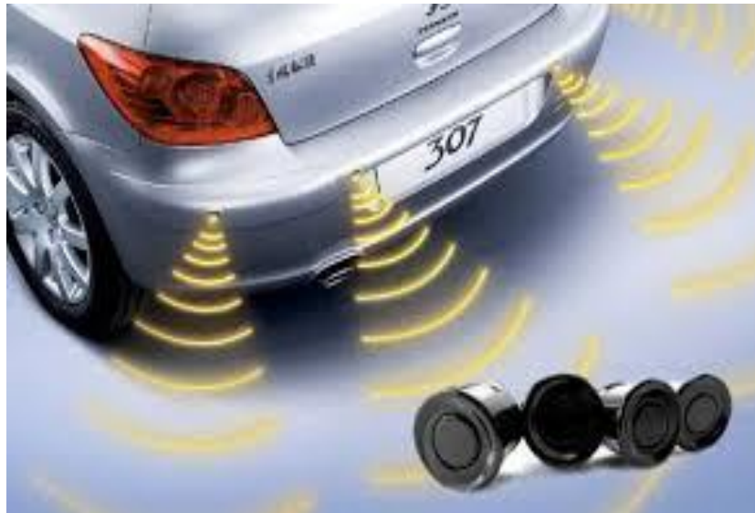
Рисунок 1 – Ультразвукове випромінення парктроніку
