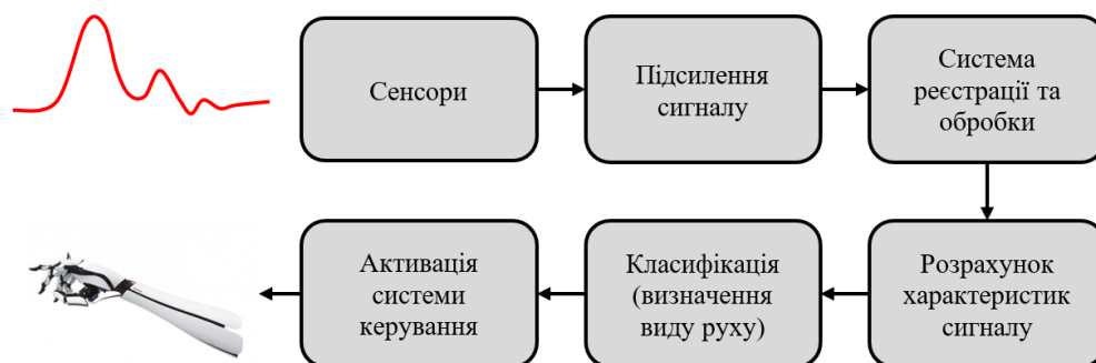
Рисуюнок 1. Узагальнена схема процесу обробки біологічної інформації у біонічному протезі кінцівки людини
