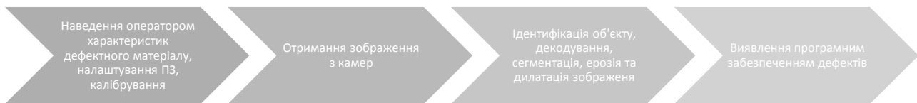
Рисунок 2. Етапи визначення дефекту виробу комп'ютерним зором
