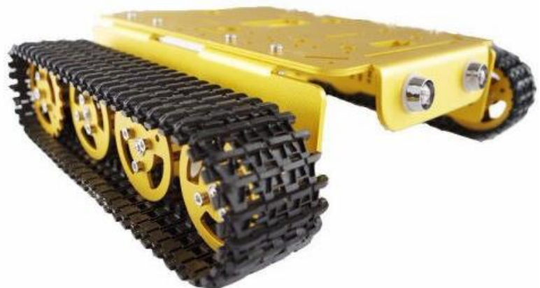
Рисунок 2. Приклад елементної бази на основі гусеничного рушія
