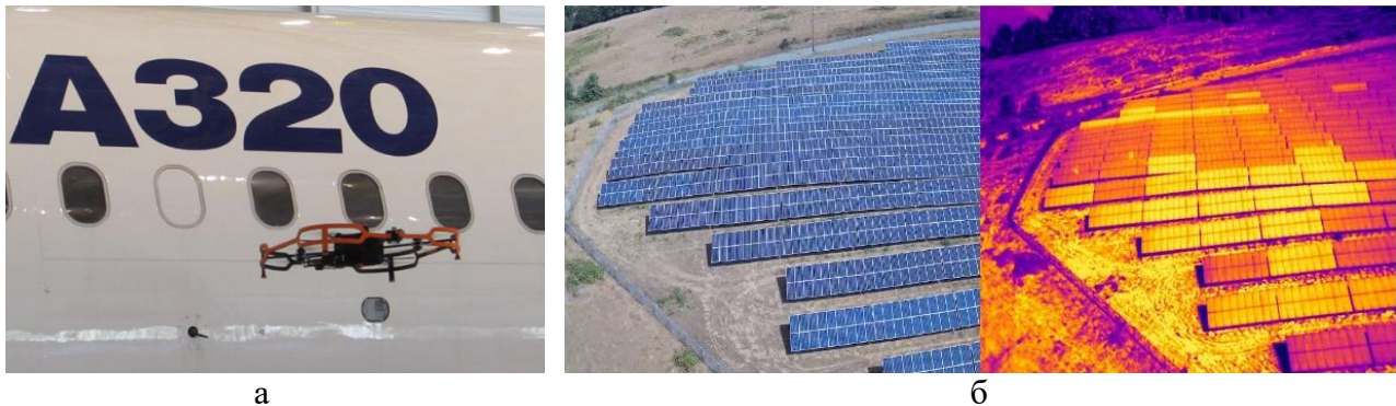
Рисунок 1. Застосування БПЛА для неруйнівного контролю об'єктів: а) діагностика фюзеляжу літака; б) контроль стану панелей сонячних батарей
