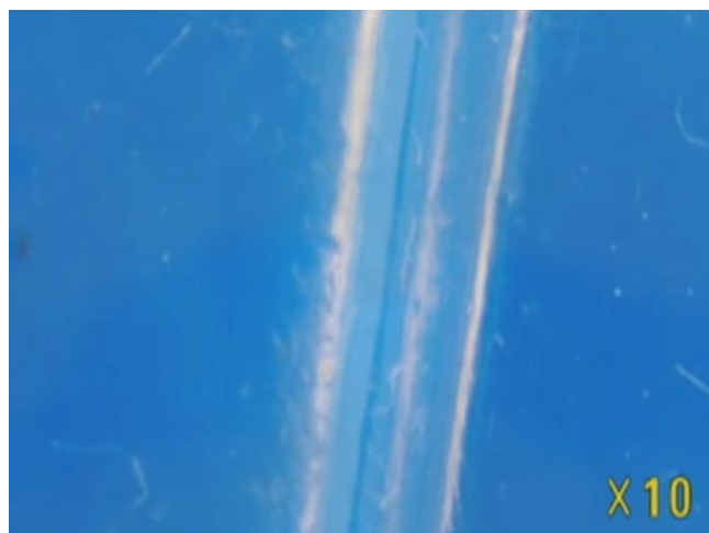
Рис. 2. Зображення поверхні деталі, що отриманої литтям пластмаси
