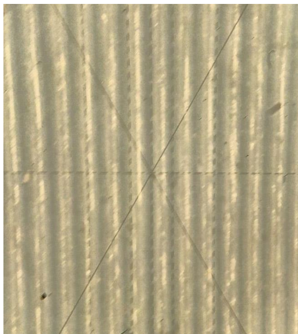
Рис. 1. Зображення бокової поверхні деталі отриманої 3D друком під мікроскопом
