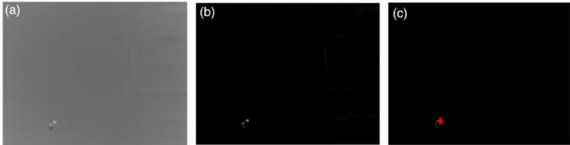
Рисунок 2. Зображення результатів виявлення (а) змінною поляризацією I^{\bar{A}-\pi/2} , (б) після обробки з використанням алгоритму I_{TP}^{\bar{A}-\pi/2} та (с) після порогової сегментації.
