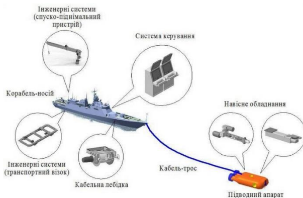
Рис. 2. Основні компоненти та структура кабельної системи керування АБПА [4]
