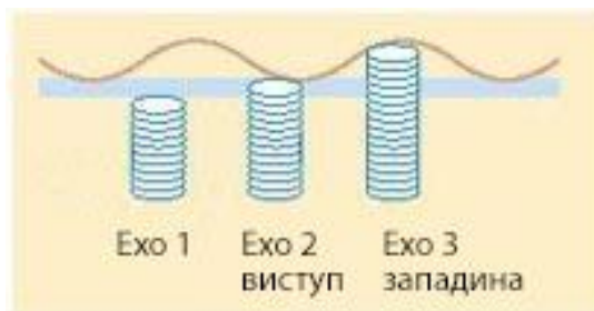
Рисунок 2 Схема роботи ультразвукового сканера
