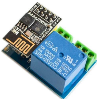
Рис.4. модуль Wi-Fi розетки на основі ESP8266
