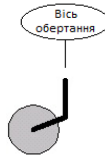
Рисунок 2. Непривідне колесо у вигляді штативу і ролика
