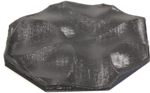
Рис. 2: Виріб з поверхнею зі складною геометрією отриманою непланарним методом.
