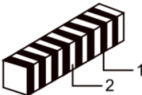
Рис. 1 Еластичний контакт компанії Fujitsu: 1 – металевий провідний шар; 2 – шар ізолятора
