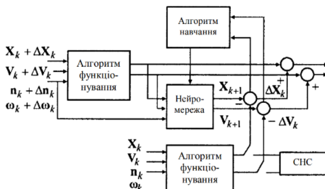
Рисунок 2 – Модель інструментальних похибок блоку акселерометрів
