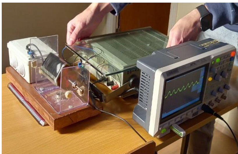
Рис. 2 Осцилографічне вимірювання частоти обертів мендосинського двигуна
