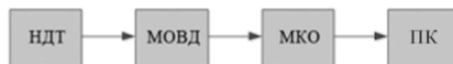
Рисунок 1. Структурна схема системи вимірювання температури НДТ – набір датчиків температури; МОВД – мікроконтролер обробки вхідних даних; МКО – мікросхема кодування та обробки; ПК – персональний комп'ютер.
