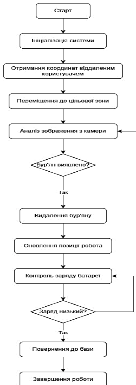
Рисунок 2. Алгоритм роботи автоматизованої системи для прополки бур'янів
