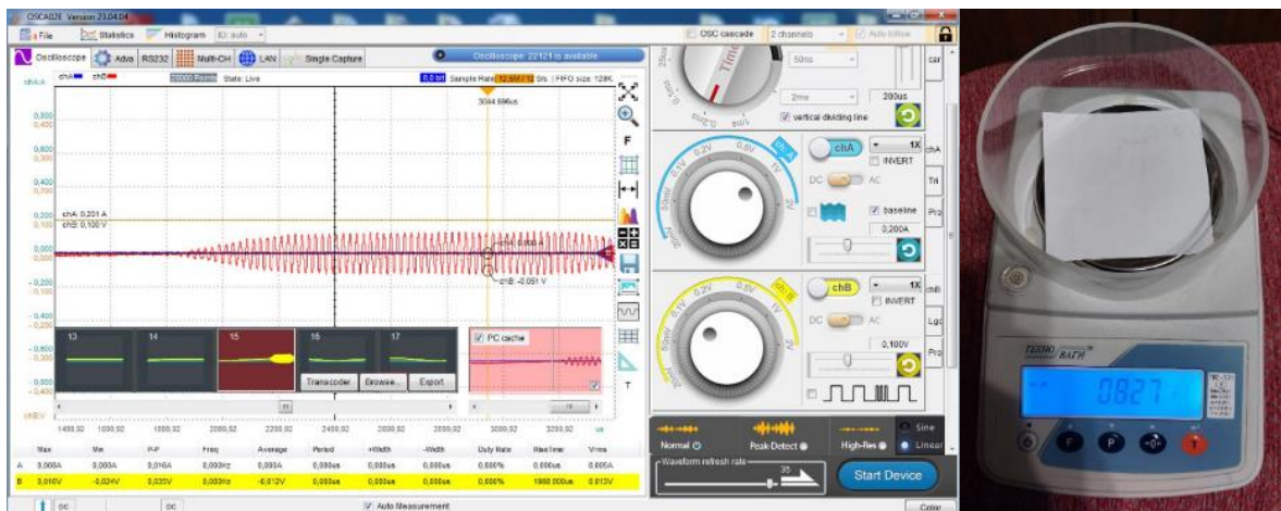
Рисунок 3 – Проходження імпульсного ультразвукового сигналу з частотою 40 кГц через папір для друку, обрахована поверхнева щільність паперу за амплітудою хвиль m_s = 86 \text{ г/м}^2 , а також визначення параметру руйнівним методом за допомогою ваг
