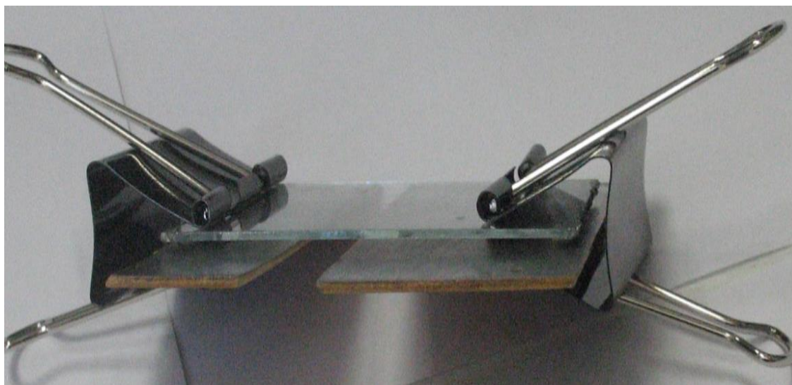
Рис. 2 Експеримент із утворення гнучкого контактного з'єднання між прозорим електродом на склі і платою
