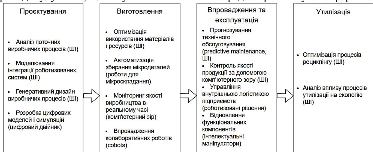
Рисунок 1. Концептуальна схема автоматизації та цифровізації приладобудування на основі сучасних методів
