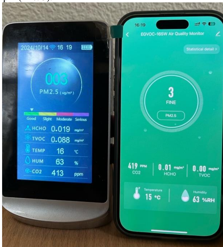
Рис. 3 Вимір концентрації пилу та інших забруднюючих речовин: синхронне відображення на екрані приладу DM72T (ліворуч) та на мобільному пристрої (праворуч)
