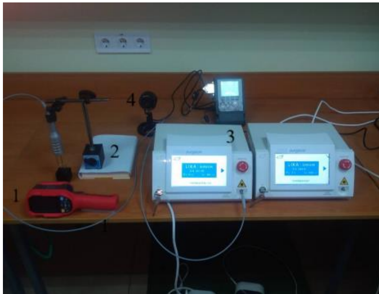
Рисунок.1 Експериментальна установка 1- тепловізор uni-t uti165K, 2- затискач, 3- лазер хірургічний діодний Lika-surgeon, 4- лазерний Ватметр.
