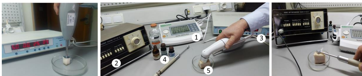
Рис.2. Експериментальна установка 1 – апарат ультразвукової терапії «Sonic-Stimu Pro UT1041», 2 – апарат ультразвукової терапії «УЗТ-1.01Ф», 3 – комбінований фізіотерапевтичний апарат «МІТ-11»; 4 – фармакологічні препарати; 5 – біологічний об'єкт
