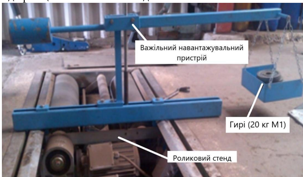
Рисунок 2. Пристрій для калібрування гравіметричним методом
