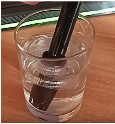
Рисунок 7. Демонстрація зняття показника кислотності датчиків занурених в оцет: а) датчик занурені у оцет; б) результат вимірювання кислотності, в) значення рН
