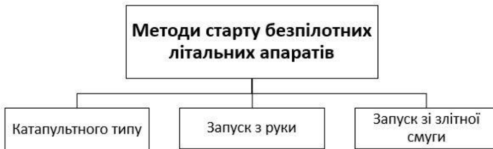
Рисунок 1. Методи старту безпілотних літальних апаратів.
