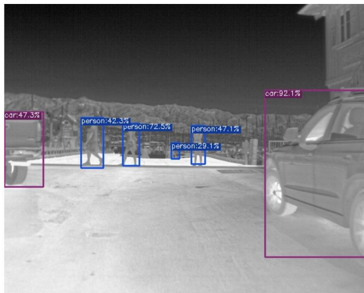
Рис.1. Розпізнавання об'єктів мережею YOLOX на валідаційних даних
