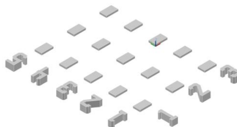
Рисунок 3. 3D моделі розпинок другого порядку (форми)
