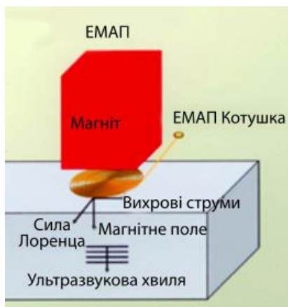
Рисунок 2. Схематичне зображення ЕМАП
