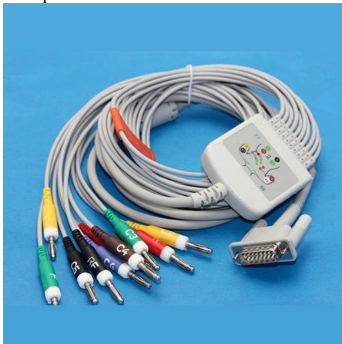
Рис. 2 Дроти відведення, аналогова схема в корпусі та дріт з роз'ємом VGA
