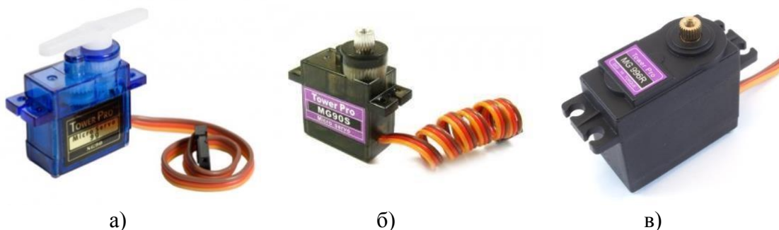
Рисунок 1. Сервоприводи: а) SG 90; б) MG 90S; в) MG 996R
