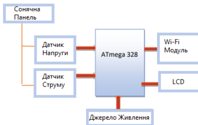
Рис. 1 Блок-схема приладу для моніторингу сонячної енергії з використанням IoT
