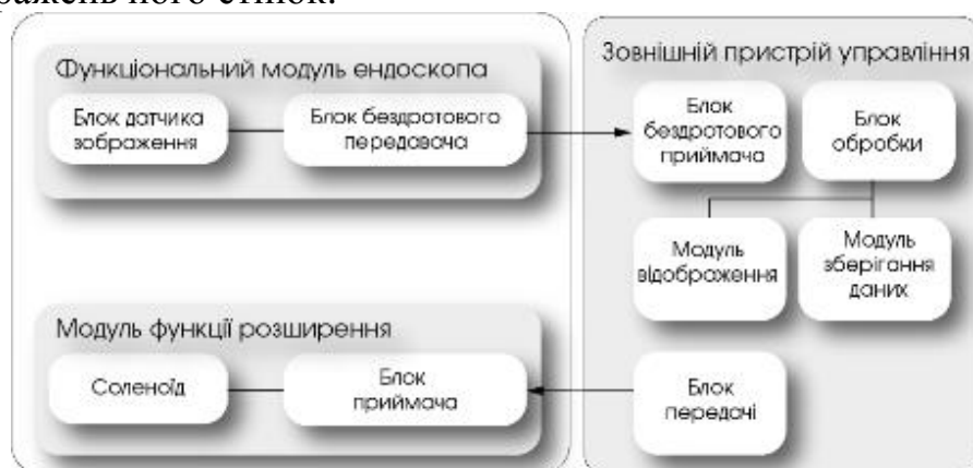
Рисунок 2. Функціональна блок-схема капсульної системи ендоскопії [5]
