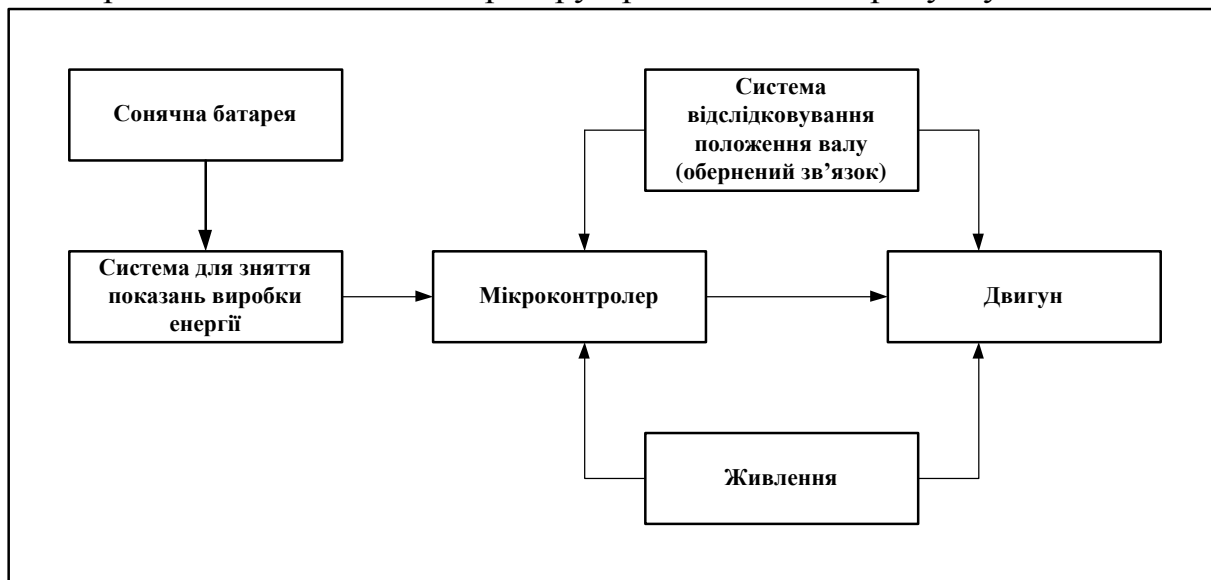
Рисунок 1. Система управління сонячною батареєю на базі однокоординатного сонячного трекера
