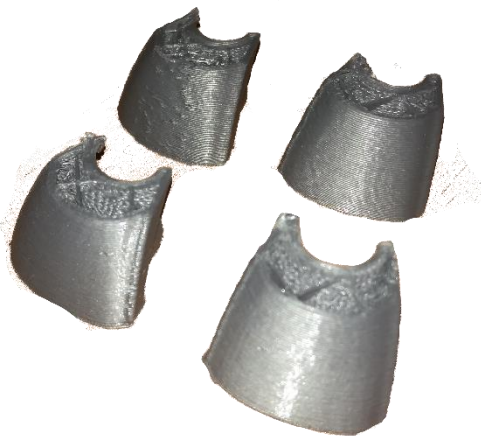
Рис. 3. Деталі, що відклеїлися в процесі друку
