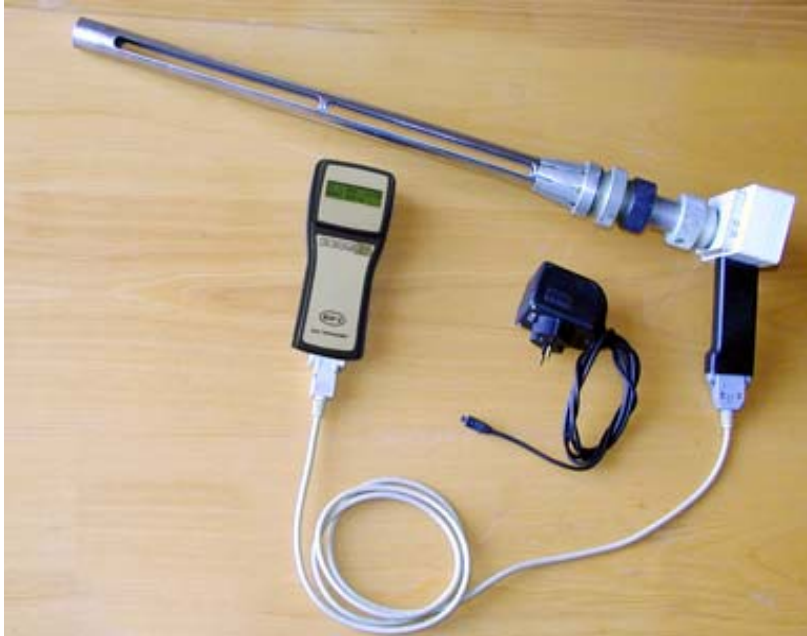
Рис. 1. Внешний вид пылемера ВОГ-2
